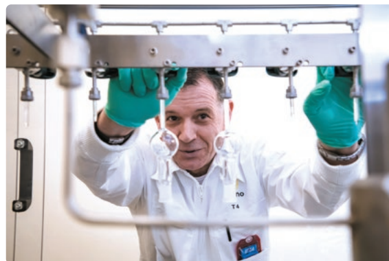
© LEA Filling a ^{85}\text{Kr} ampoule
